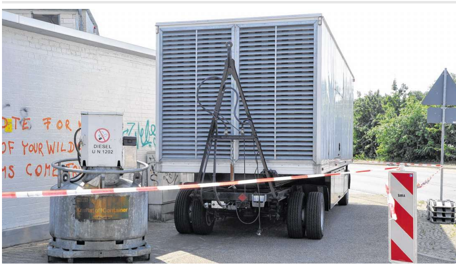
Ein mobiles Notstromaggregat der MVV Energie AG, wie es bei größeren Stromausfällen zum Einsatz kommt.
